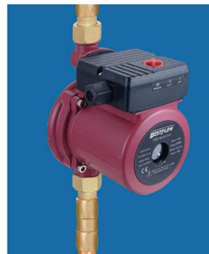
Para evitar ruido por cavitación y riesgos de daños a los descansos, se requiere de una presión mínima de 2 metros columna de agua (0.2 bar) en la succión de la bomba mientras ésta funciona.
